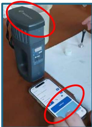
La standardizzazione di **AuroraNIR** avviene attraverso i riferimenti interni. Prima di effettuare le scansioni, si appoggia lo strumento su una superficie piana (ad esempio un tavolo), si clicca il pulsante di acquisizione e lo strumento acquisisce automaticamente il 'dark' e il 'reference'.
